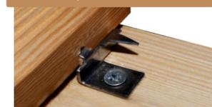
**Шиповые крепежи** разработаны только для доски с прямым профилем любой ширины; монтаж характеризуется тем, что крепёж, оснащенный специальной заостренной планкой, или шипом, фиксируется на лаговом брусе, а соединение досок частично или полностью производится путем накаливания на шип крепежа.
