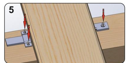
Для установки первой доски с крепежами группы Змейка-Универсал и Змейка-Атлант используется Фиксатор ФУЦ. Закрепите двумя шурупами ФУЦ на лагах. Первая доска заводится выступающими концами в пазы Фиксатора. Крепеж Змейка крепится к лаге шурупом через отверстие на голове Змейки.
