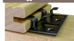
**Пазовые крепежи** предназначены для установки террасной пазовой доски и для фасадной облицовки (блок-хауса, евровагонки); ассортимент этого типа доски отличается возможностью изготовления пазовой доски с различной высотой нижнего паза (3-11 мм) и глубиной нижней полки паза (6-15 мм); монтаж осуществляется пазовыми крепежами: в профрезерованные пазы доски входят "крылья" крепежа, прочно ее фиксируя на лаговой или направляющей конструкции.
